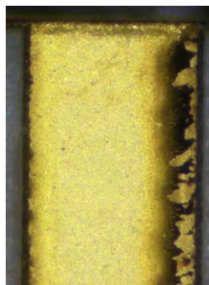
Figure III-32: Traces de brûlures sur l'échantillon dues à la puissance élevée délivrée par le laser
