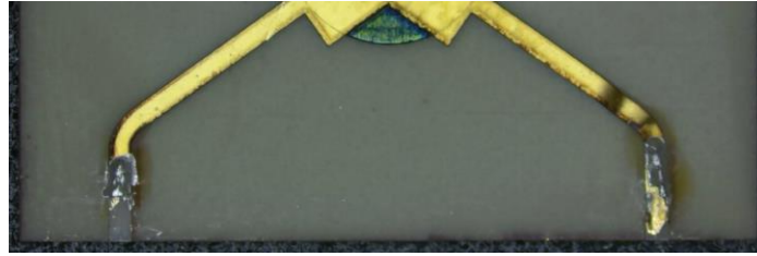
Figure III-33: Lignes microstrip détériorées au niveau des zones de fixation des connecteurs
