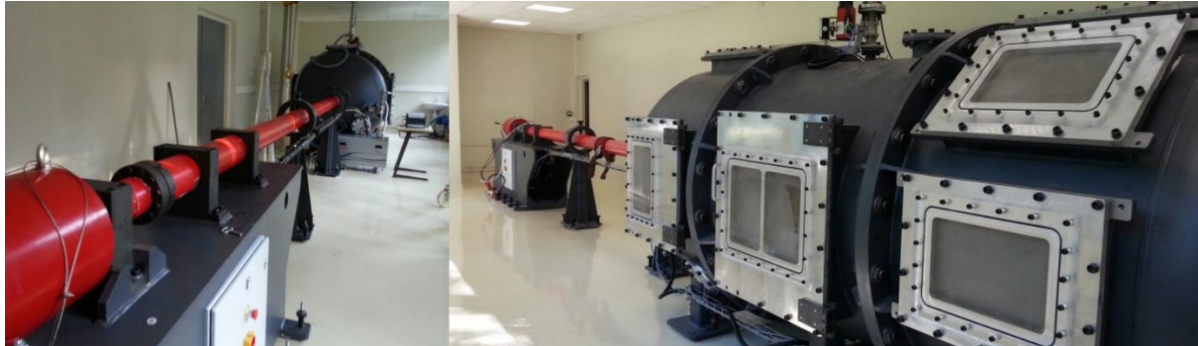
Figure 97 : Différentes vues du montage du lanceur à gaz
