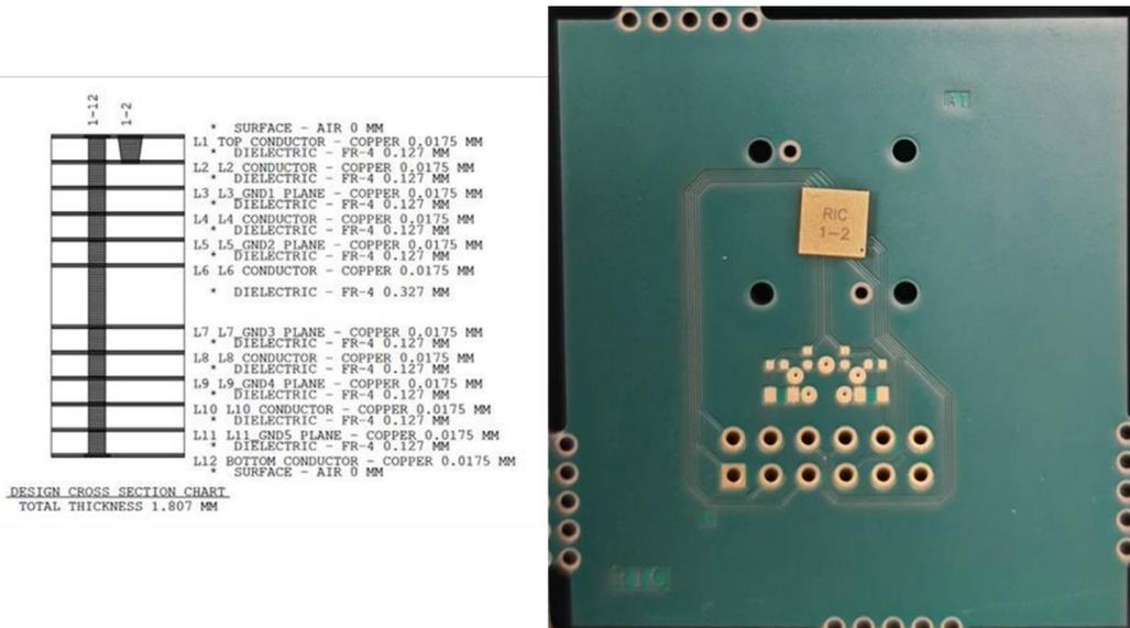
Figure 111 : Gauche : Données des couches du PCB, Droite : VT4x4 RIC assemblé sur PCB
