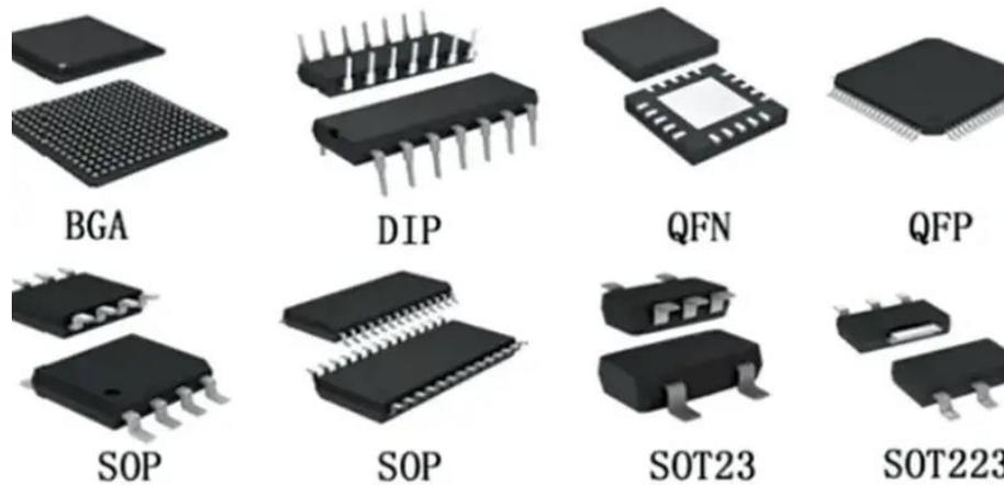
Figure 6 : Différents types de boîtiers électroniques [21]
