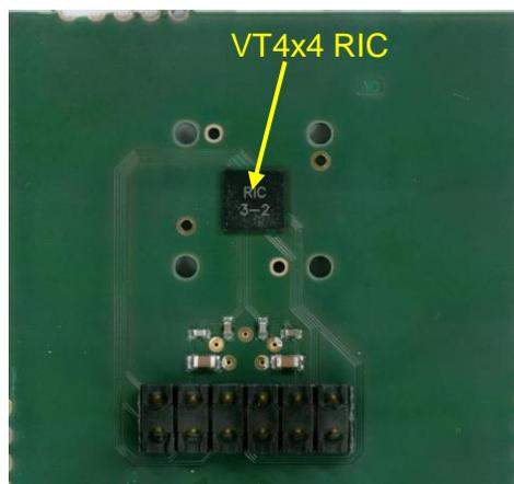
Figure 143 : VT4x4 RIC sur PCB multicouche sans ouverture côté PCB
