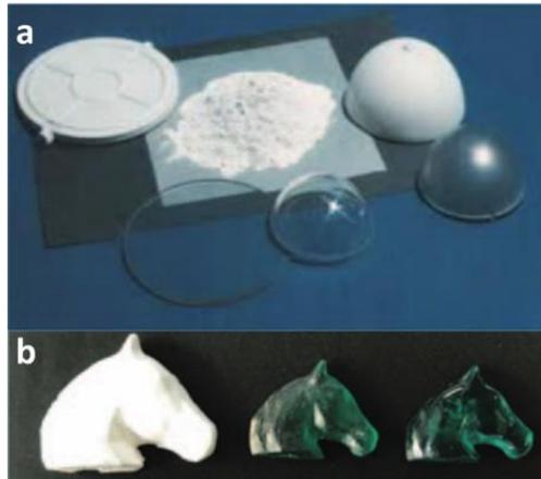
Figure 19 : Pièces crues et frittées mises en forme par coulage sous pression (a) et coulage-gélification (b) [62].
