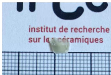
Figure 133 : Photographie de l'échantillon transparent de YAG Pf60.
