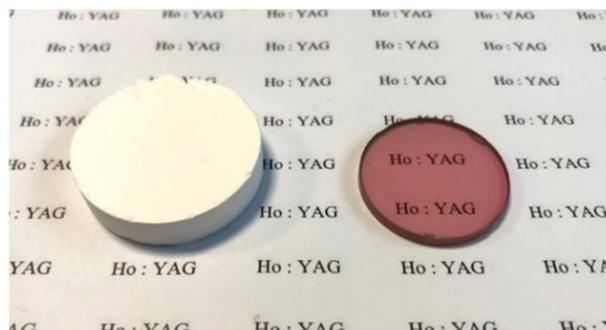
Figure 22 : Exemple d'échantillons cru de YAG:Ho puis totalement dense après traitement thermique de frittage et polissage [106].
