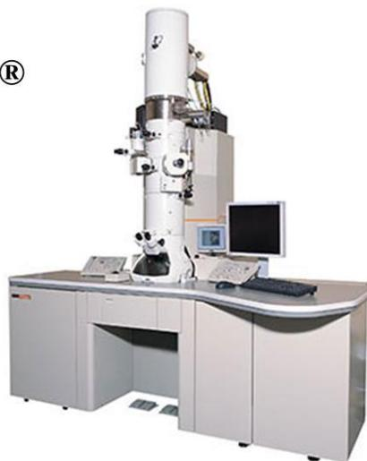
Figure 145 : Microscope haute résolution utilisé est un 2100F, JEOL, Kyoto, Japon [3].
