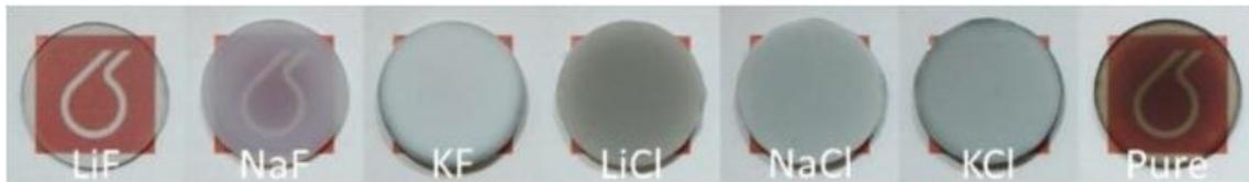
Figure 36 : Echantillons de  $MgAl_2O_4$  frittés par SPS à  $1100^\circ C$  avec différents additifs de frittage de type halogénure alcalin [141].
