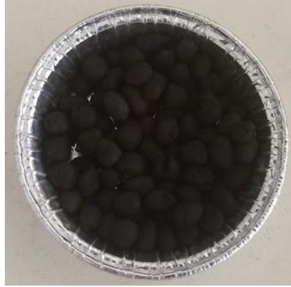
Figure 40 : Photographie illustrant les billes composites sèches mises en forme par mélange de poudres.
