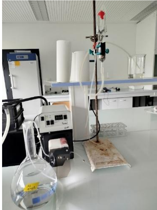
Figure 26 : Configuration de la mise en œuvre du procédé d'adsorption en colonne
