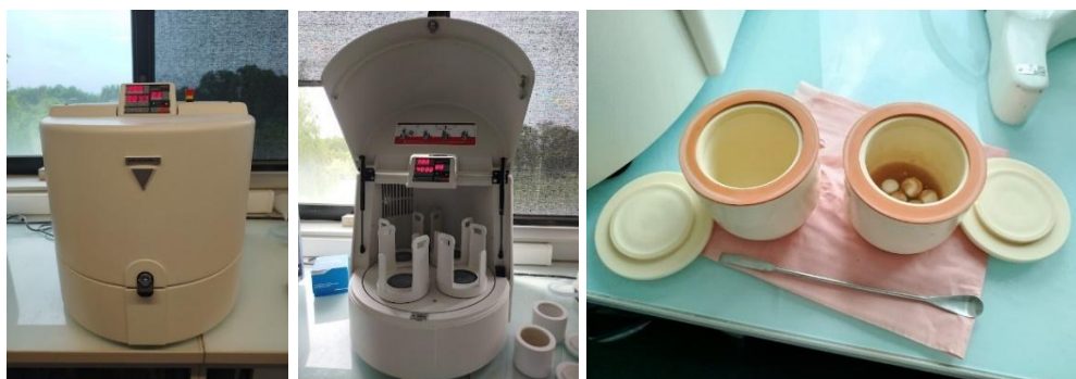
Figure 21 : Préparation du gel de psyllium dans le broyeur planétaire Pulverisette 5 FRITSCH
