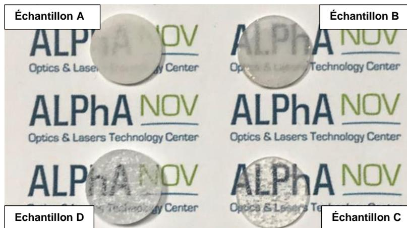
Figure 40 : Échantillons obtenus après frittage par flux visqueux
