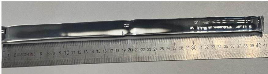
Figure 33 : Préforme YAP vitrifiée suite au traitement des cylindres sous gaz de  $C_2F_6$ .
