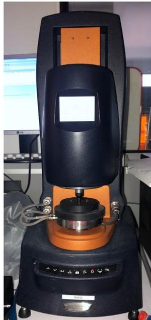
FIGURE 4.4 – Rhéomètre utilisé au laboratoire du CASC
