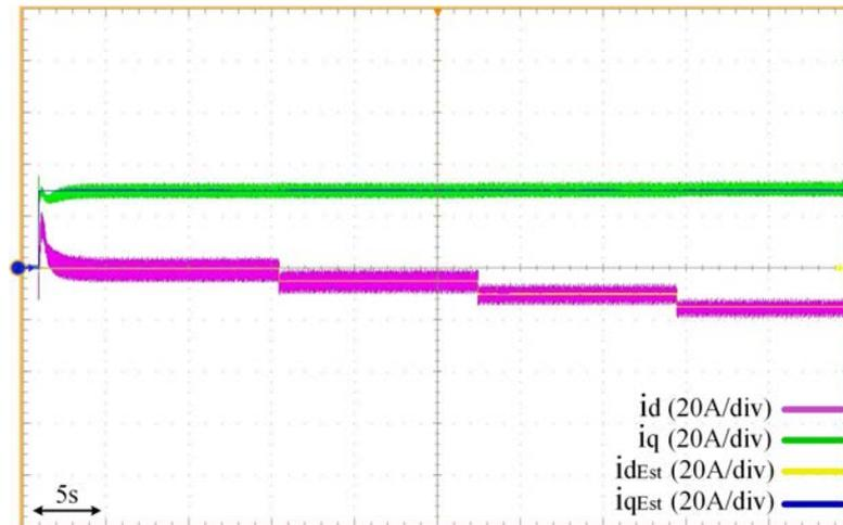
FIGURE 4.24 – Courants estimés et mesurés lorsque  $i_d$  change
