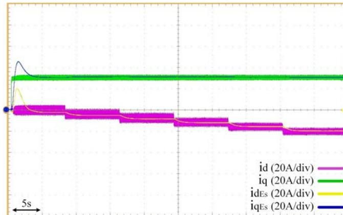
FIGURE 4.17 – Courants estimés et mesurés lorsque  $i_d$  change pour  $i_e = 6A$ .
