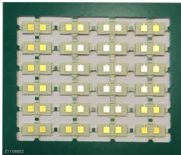
Figure IV-8 : Cellules unitaires double fabriquées par Eurocircuits.
