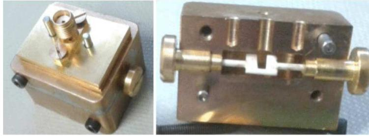
Figure I-42 : Résonateur céramique diélectrique en forme de U [81].
