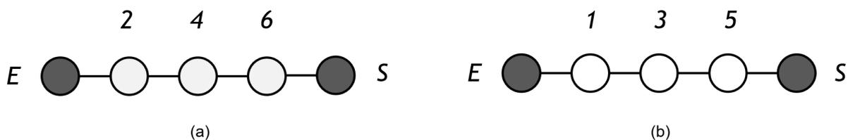
Figure II-3 : Diagrammes de couplage des filtres passe-bande de type Chebyshev d'ordre 3
