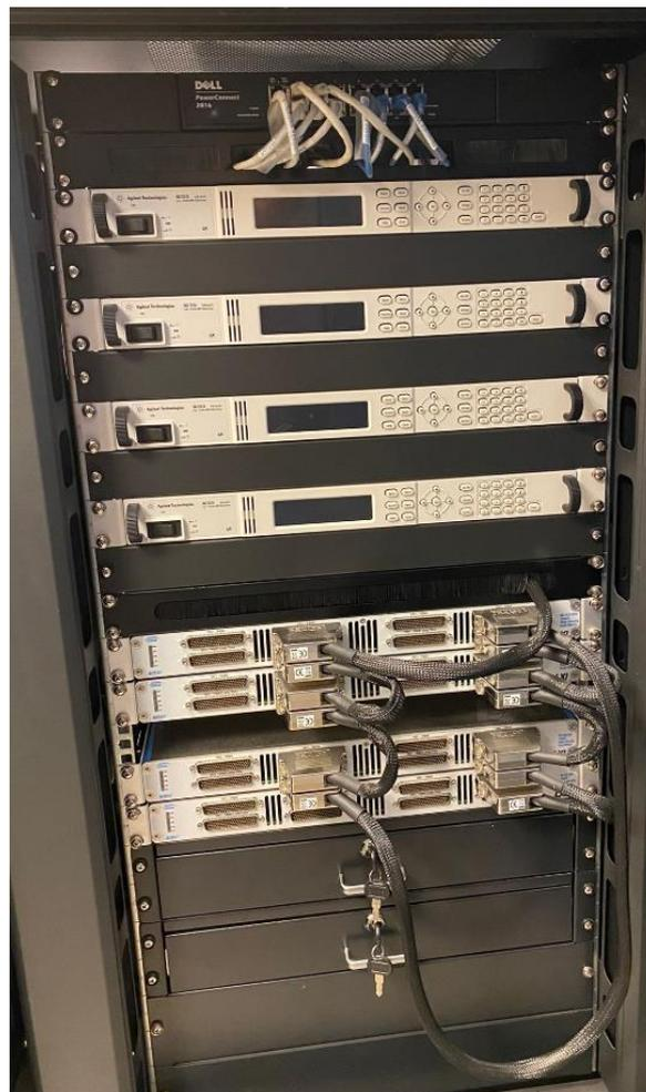
Figure IV. 36: Banc de pilotage et d'alimentation DC multivoies.
