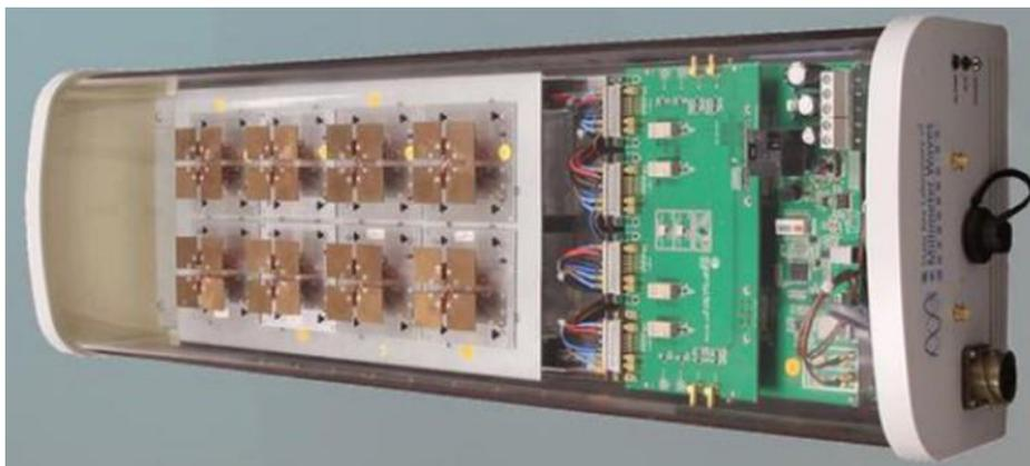
Figure I. 14: Antenne pour la 4G.
