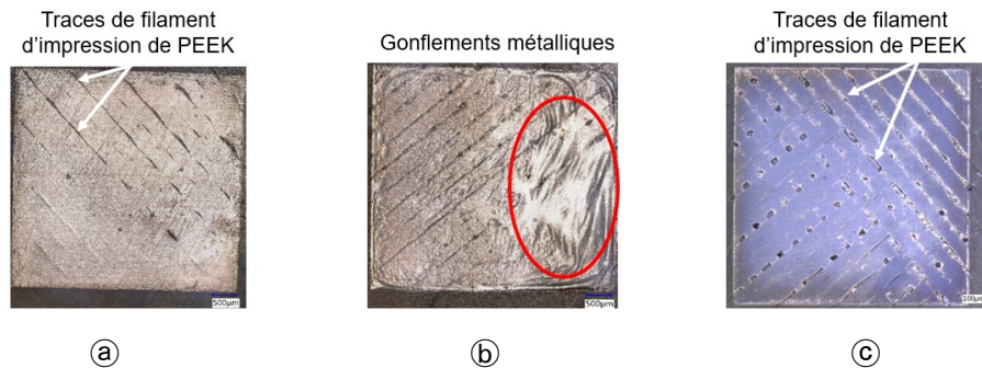
Figure IV-18 : Images microscopiques des carrés imprimés en AJP sur le substrat PEEK, carré 4 (a), carré 5 (b) et carré 6 (c).
