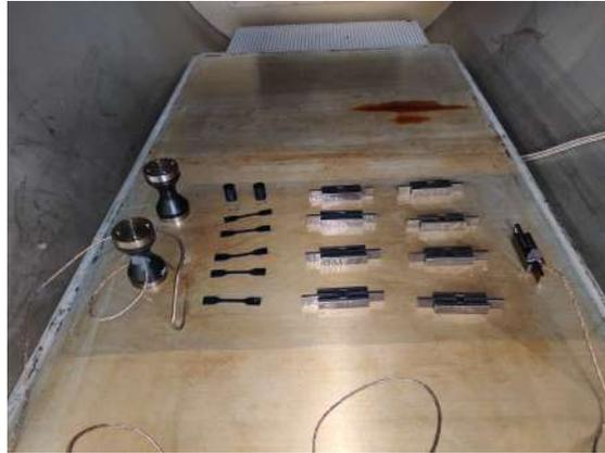
FIGURE A.1. – Cuisson des éprouvettes d'élastomères à l'autoclave - 1
