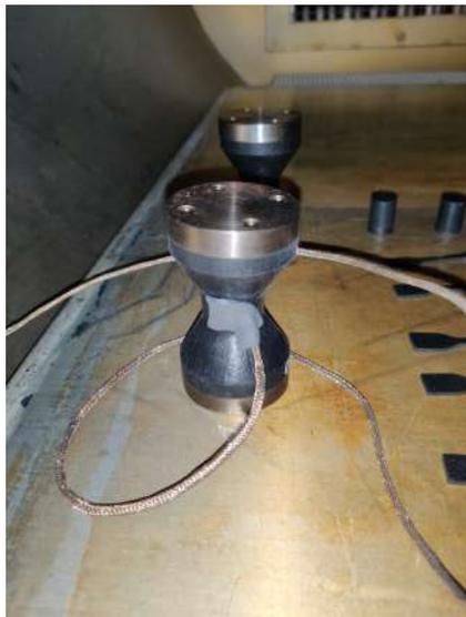
(a) Thermocouple de contrôle dans diablo
