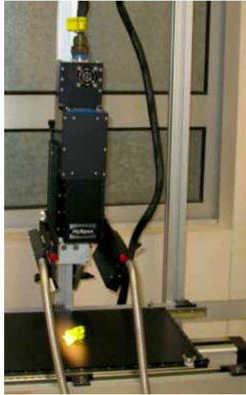
FIGURE 3.7 – La caméra HySpex du LARIS durant l’acquisition du cube hyperspectral d’une feuille. Source : LARIS.
