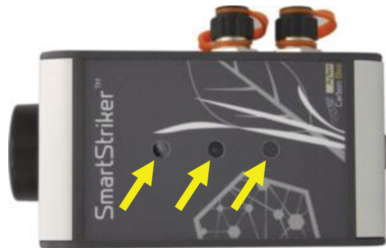
FIGURE I.4 – La caméra Carbon Bee vue de face. Les trois flèches jaunes indiquent les positions des objectifs des trois capteurs. Source : Carbon Bee AgTech.
