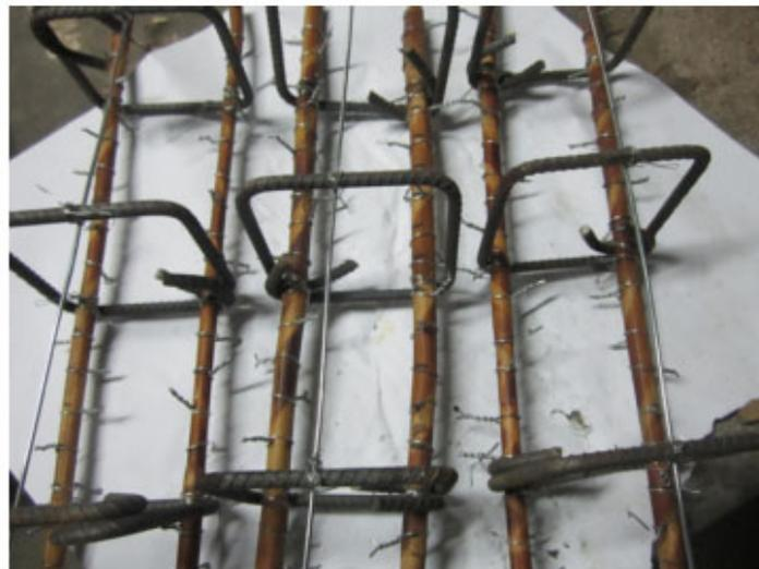
Figure 1-28: Armatures des poutres en flexion [106]
