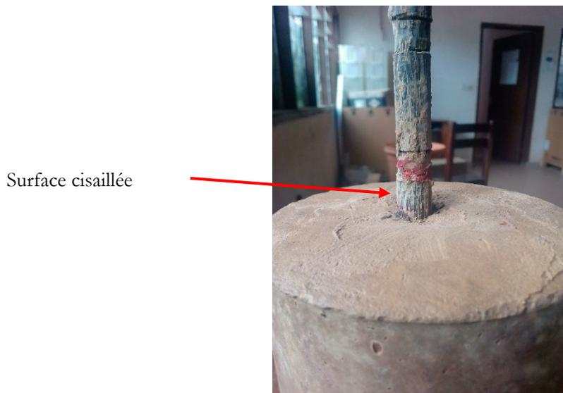
Photo 4-11 : Glissement de l'armature du bloc de béton de latérite
