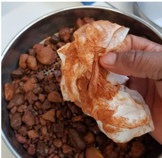
Figure 2-4 : Dépôt de particules sur les papiers nettoyants
