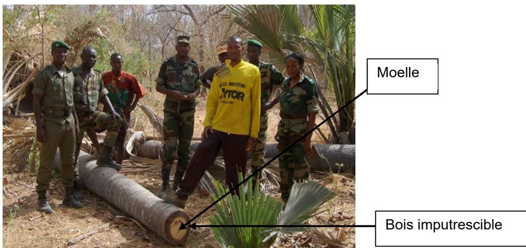
Photo 1-3 : Coupe transversale d'un tronc de rônier [25]
