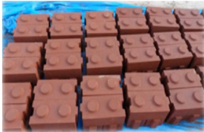
Figure 1-5 : Brique en géobéton [23]
