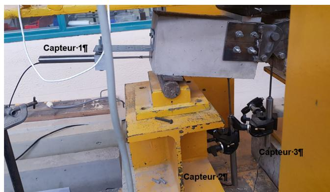
*Photo 4-5 : Disposition des capteurs de déplacement pendant l'essai*
