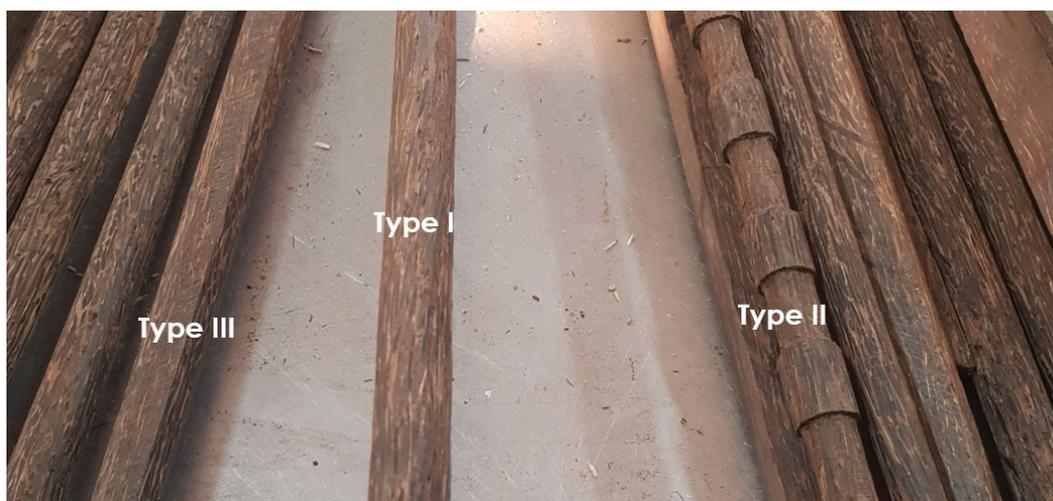
Photo 4-1 : Echantillons des différents types d'armatures
