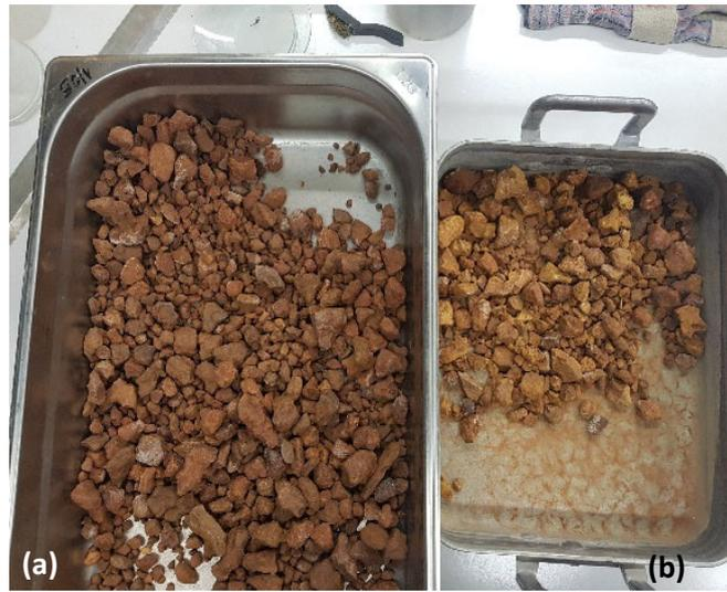
Figure 2-5: (a) nodules de latérites dures, (b) argile consolidée et sable consolidé
