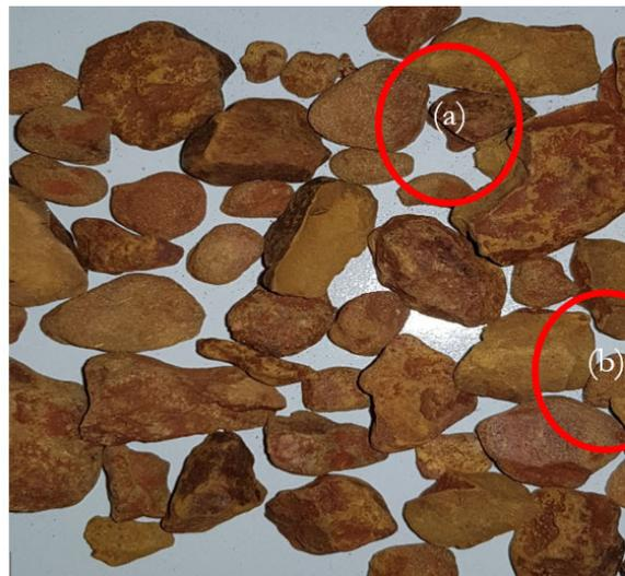
Figure 2-3 : (a) Sable consolidé, (b) argile consolidée
