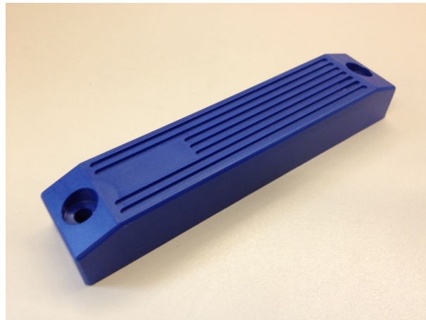
FIGURE 1.13 – Transpondeur RFID actif classique dans son boîtier
