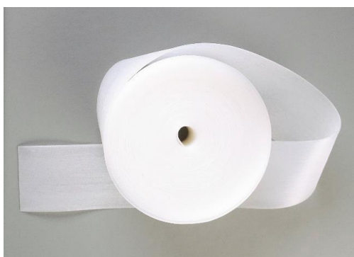
Figure II-19 : Photo d'un matériau modèle de Si-XLPE obtenu par extrusion [1].
