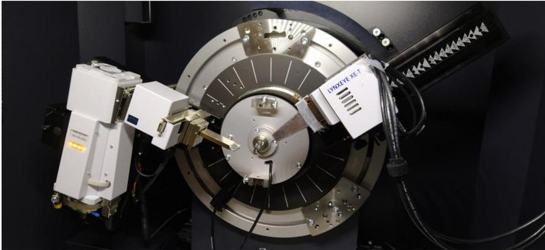
FIGURE 2.7 – Montage Bruker D8 Advance utilisé pour les expériences de diffusion totale des rayons X.
