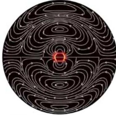
FIGURE 1.11 – Représentation des lignes de champ pour le mode dipolaire d'une nanoparticule. La carte de couleur représente l'intensité du champ électrique.
