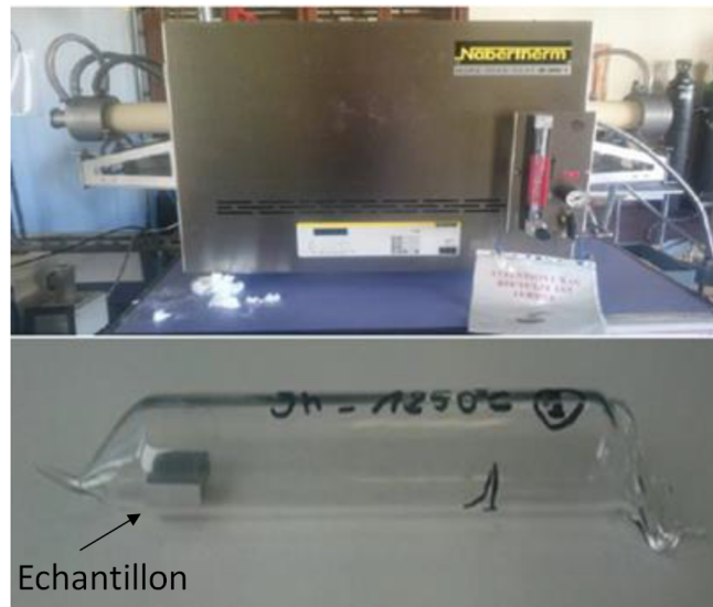
FIGURE II.3.3.1 – Four de traitement thermique
