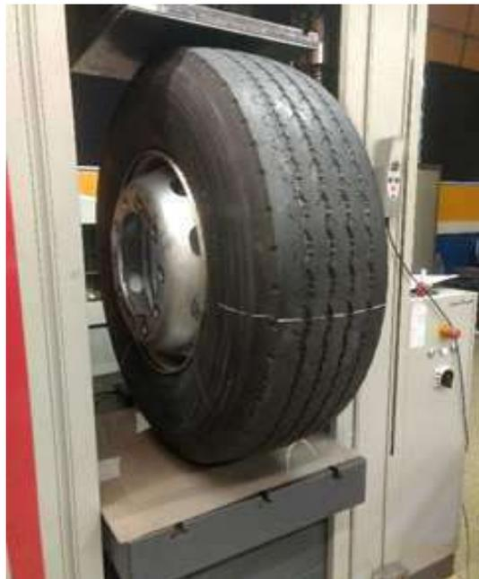
FIGURE 4.3 – Essai de compression sur Pneu
