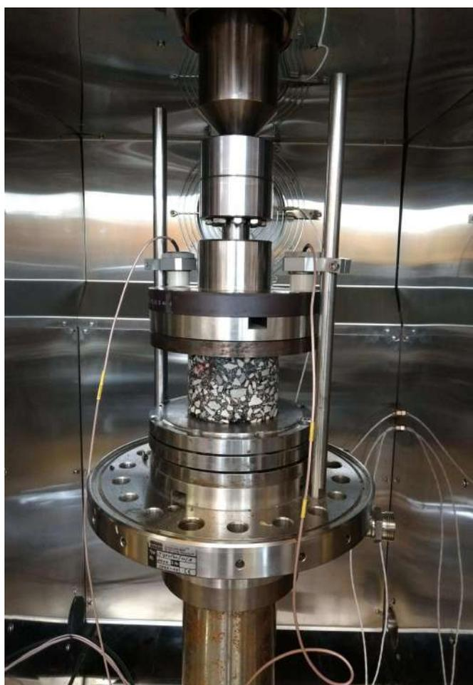
FIGURE 5.17 – Dispositif du montage de l'éprouvette instrumentée par deux capteurs de déplacement à courant de Foucault
