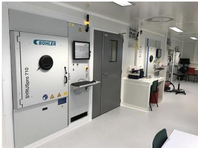
Figure 10 : Salle blanche et machines d'évaporation de la plateforme technologique de l'Espace Photonique
