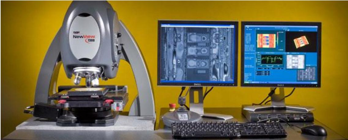
Figure 14 : Profilomètre optique Zygo NewView 7300 de la plateforme technologique de l'Espace Photonique
