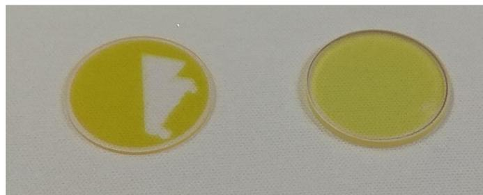
Figure 39 : Test au scotch d'une monocouche d' $As_2S_3$  de  $990 nm$  d'épaisseur déposée sur un substrat de B270. A gauche sans couche d'accroche, à droite avec une couche d'accroche de  $2 nm$  de  $MgO$
