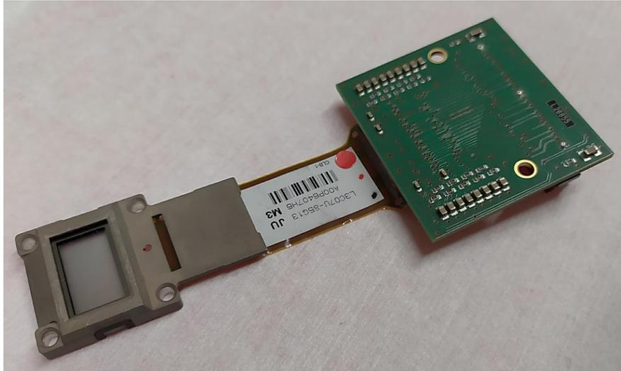
Figure 75 : Image du modulateur spatial de lumière (LCD) avec le connecteur pour la carte principale
