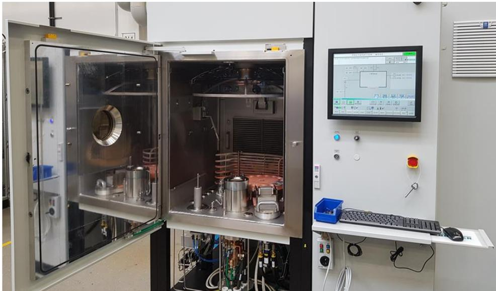
Figure 11 : Machine de dépôt avec assistance plasma SYRUSpro dans l'espace photonique (à gauche) et vue interne du bâti de la machine SYRUSpro (à droite)
