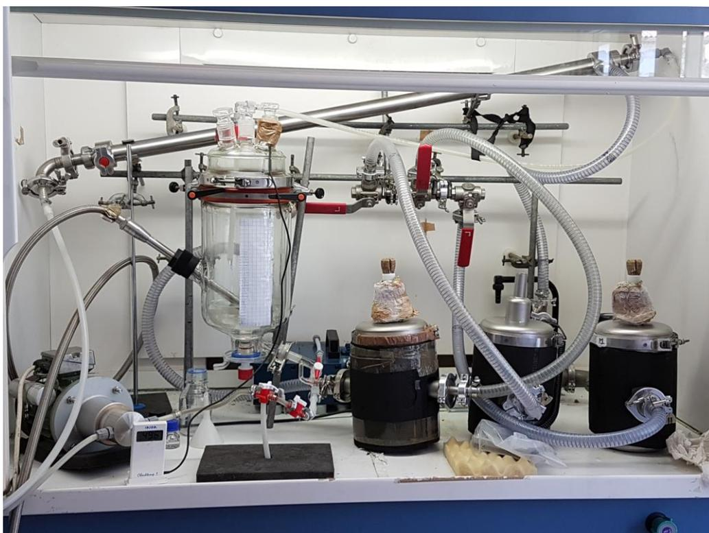
**Figure II-3** : Illustration du dispositif expérimental de la pervaporation appliqué à l'échelle laboratoire
