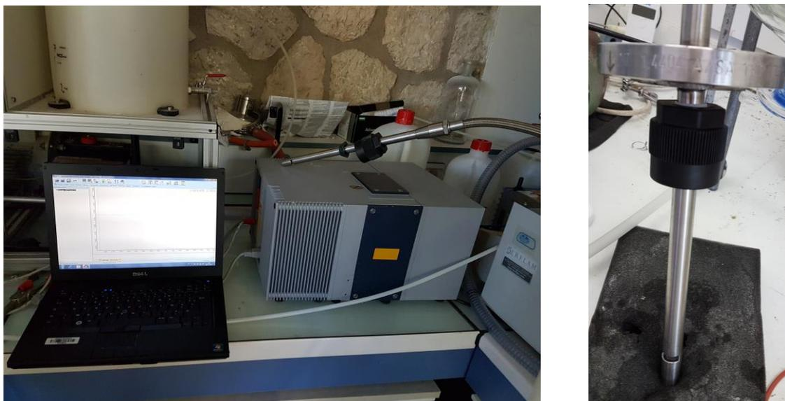
**Figure II-6** : Dispositif PIR utilisé pour la quantification en ligne de la pervaporation
