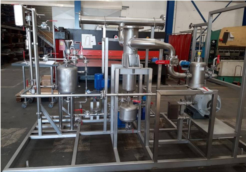
Figure II-10 : Représentation globale du bâti du pilote semi-industriel de pervaporation « PEPS »
