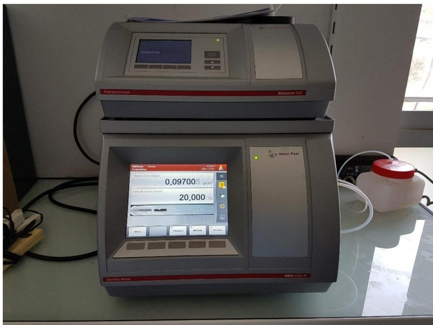
**Figure II-8** : Densimètre utilisé pour les mesures de masses volumiques à travers les mélanges binaires
