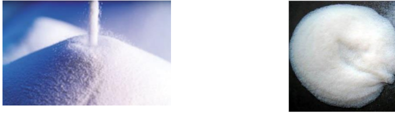
Figure 124 : Poudres de silices amorphes : à gauche : silice précipitée, à droite silice pyrogène.
