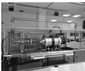
Figure 19 : Schéma du dispositif de génération d'aérosols de la méthode de dustiness du tambour rotatif (RD).
