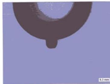
**Figure 27 : caractéristiques dimensionnelles d'une entaille étalon longitudinale interne et sa réplique**
