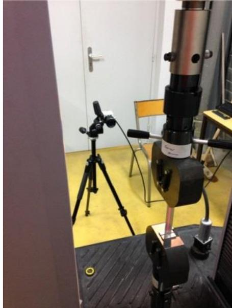
**Figure 4.2.2.2.1** : Presse MTS et dispositif de corrélation d'images
