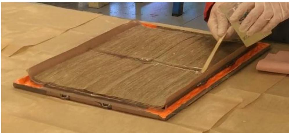
**Figure 5.3.7.1** : Imprégnation manuelle d'un pli de résine dans le moule
