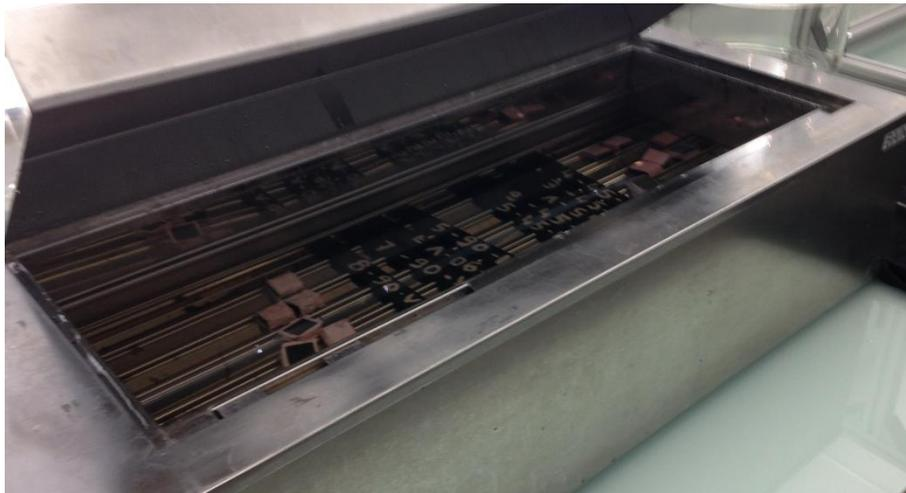
**Figure 6.2** : bain statique pour l'immersion à 70 °C
