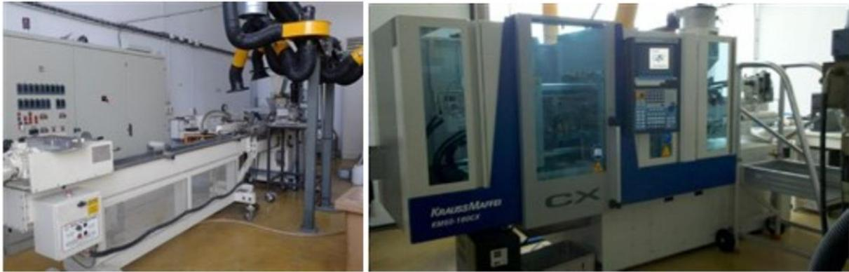
Figure 58 : Extrudeuse et presse à injecter utilisées pour la mise en œuvre des échantillons
