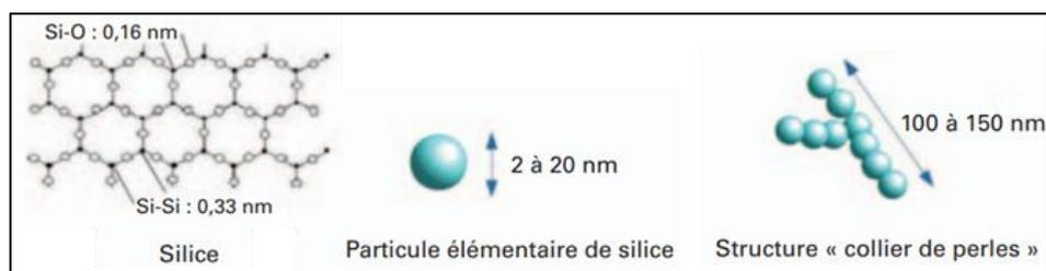
Figure 46 : Structure de la silice<sup>127</sup>
