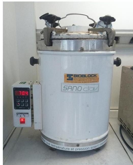
Figure 59 : Dispositif de vieillissement utilisé
