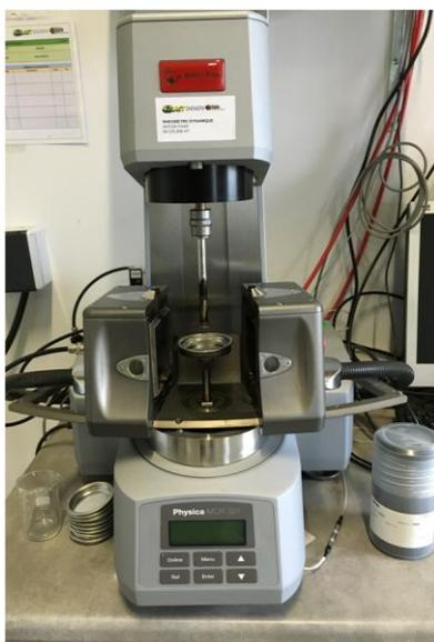
**Figure 61 : Rhéomètre utilisé pour la détermination de viscosité**
