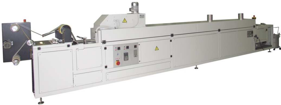
(C) Grande échelle [5] : largeur de coulage jusqu'à 500 mm, vitesse de coulage jusqu'à 6 \text{ m} \cdot \text{min}^{-1} , longueur de la section de séchage jusqu'à 20 m
