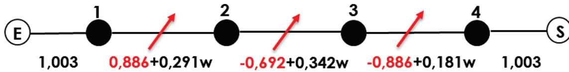
Figure III-8: Diagramme de couplage avec deux couplages dispersifs positifs et un négatif
