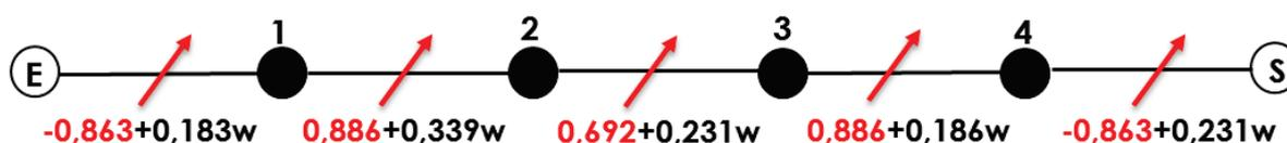
Figure III-23: Diagramme de couplage avec trois couplages inter-résonateurs positifs et deux couplages entrée-sortie négatifs
