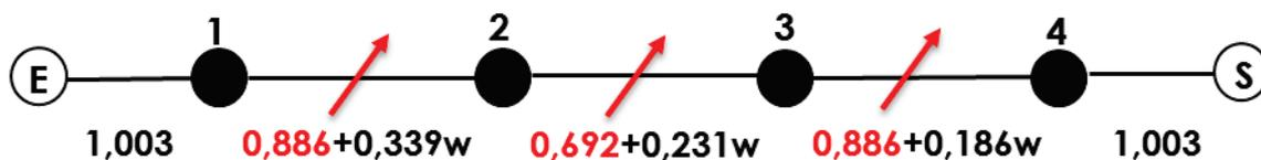
Figure III-12: Diagramme de couplage avec trois couplages dispersifs positifs
