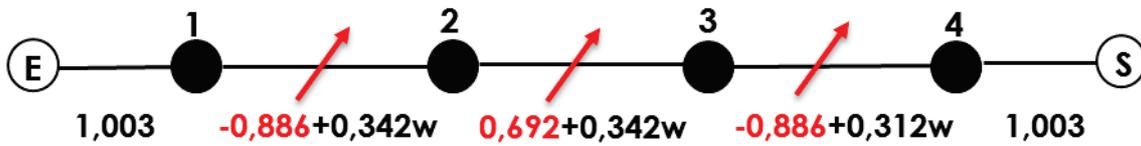
Figure III-6: Diagramme de couplage avec deux couplages dispersifs négatifs et un positif
