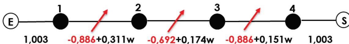
Figure III-10: Diagramme de couplage avec trois couplages dispersifs négatifs
