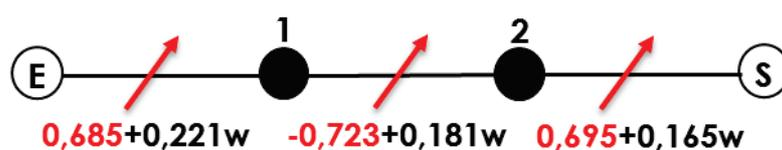
Figure III-18: Diagramme de couplage du filtre deux pôles à couplages d'entrée-sortie dispersifs
