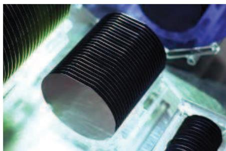
Figure III-3 : Photographie d'un barreau de wafers en AsGa [65]
