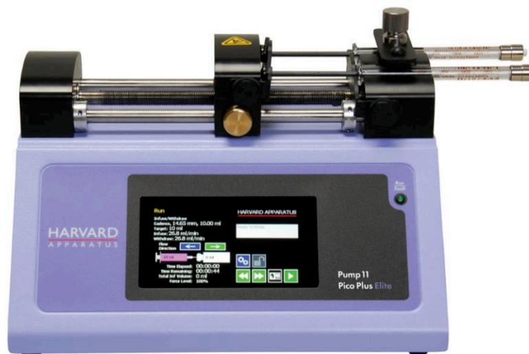
**Figure 23.** Représentation du pousse-seringue Pico Plus (Harvard Apparatus).
