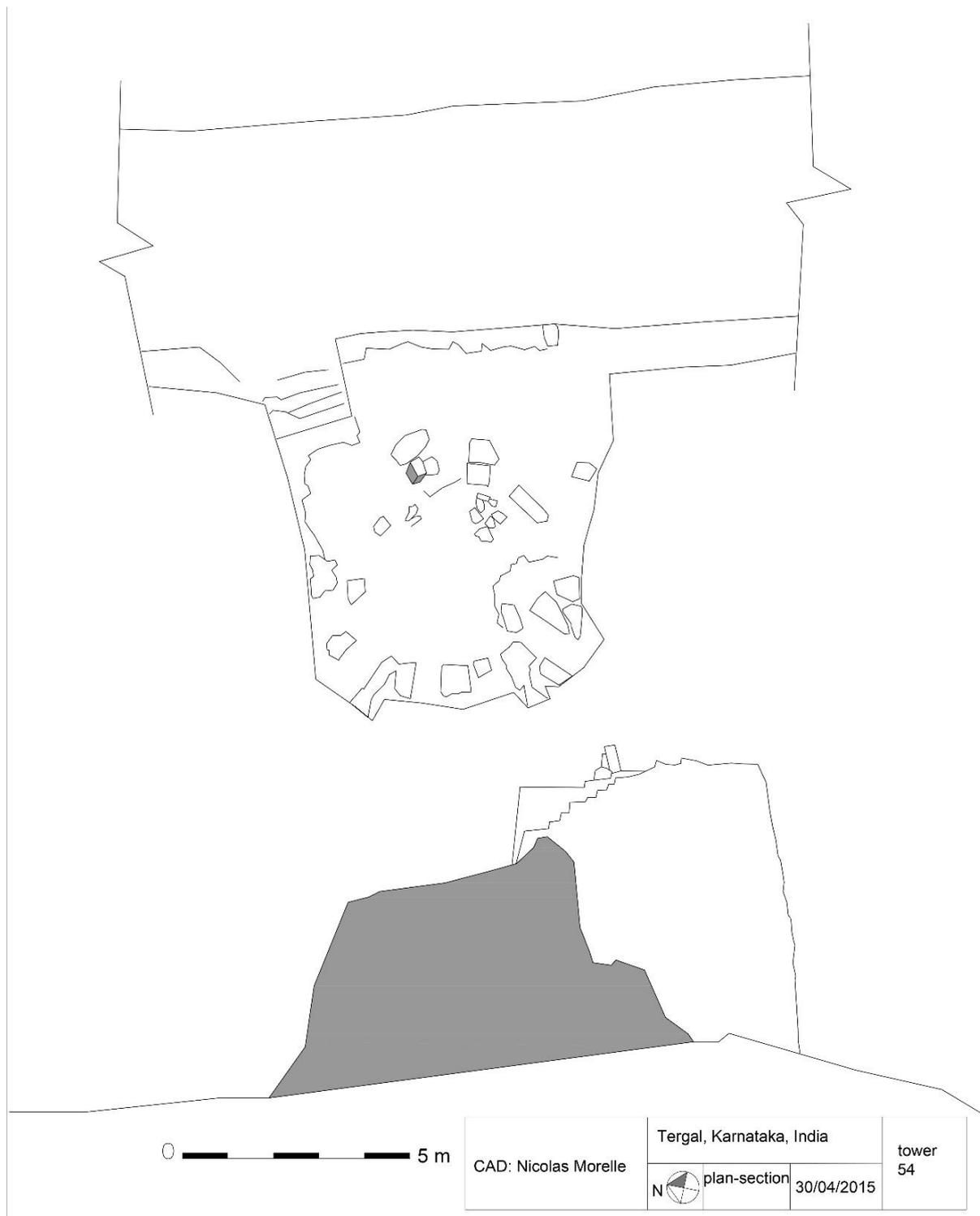
**Figure 171 : plan et coupe de la tour 54, ouest. La plate-forme est adaptée à l'artillerie pour accueillir un canon sur pivot à la fin du 16<sup>ème</sup> siècle**
