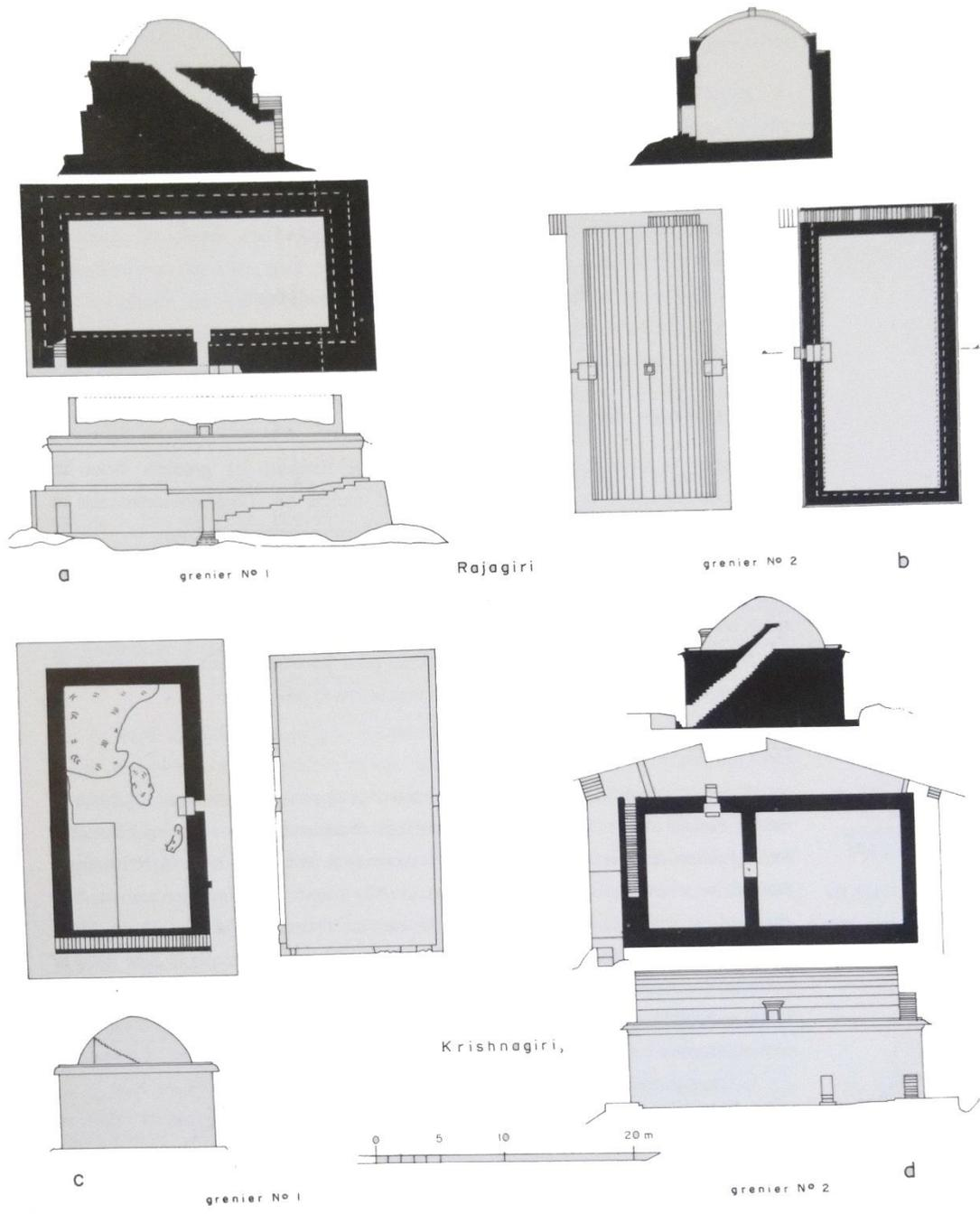
Fig. 37. Greniers sur les montagnes (SAV) : Rajagiri, grenier N°1, coupe, plan et élévation, grenier N°2, coupe et plan ; Krishnagiri, grenier N°1, plan et élévation, grenier N°2, coupe, plan et élévation.
