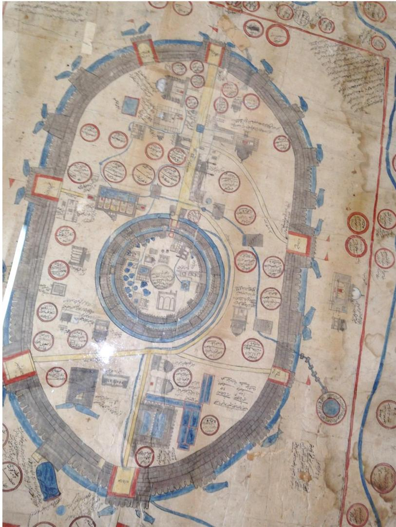
**Figure 392 : plan de Bijapur réalisé au 17<sup>ème</sup> siècle mentionnant la position des canons et le flanquement des tours et murailles (conservé au musée de Bijapur). Le flanquement ne s'opère pas de face, mais sur les flancs des tours se protégeant mutuellement**
