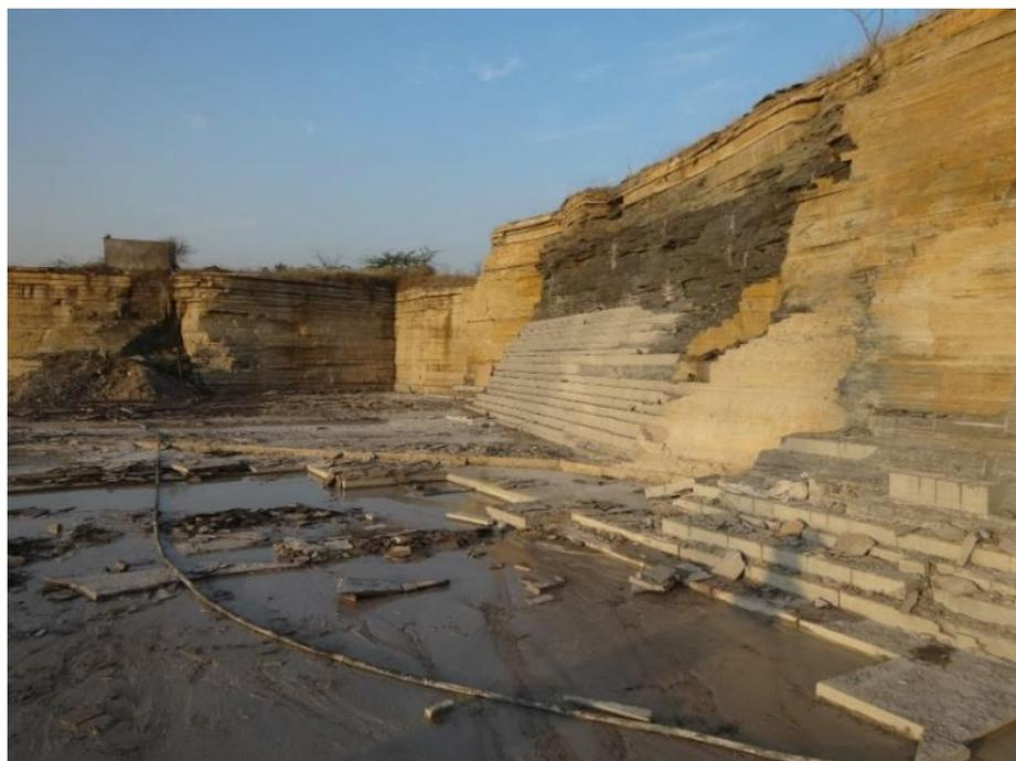
**Figure 29 : exploitation par plaques de la carrière de Fartabad (à quelques kilomètres au nord de Firozâbâd, proche de Shahabad)**
