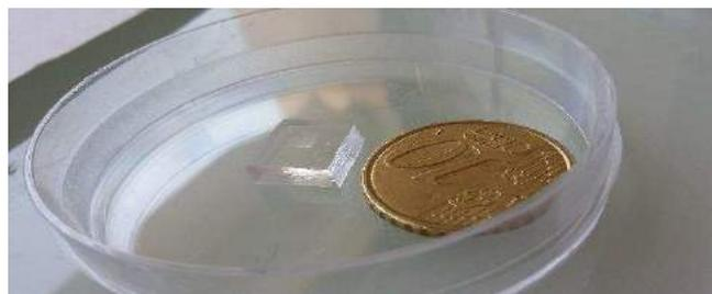
**Fig. 4.21** : Tampon de PDMS d'environ un cm<sup>2</sup>, la zone qui sera imprimée correspond à la petite partie opaque au centre du tampon qui contient une répétition de cercles à une taille donnée.
