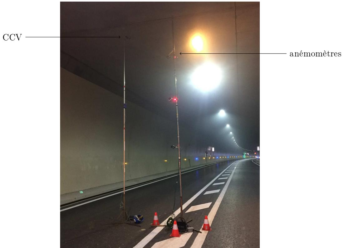
FIGURE 3.20 – Perches de mesures en tunnel.
