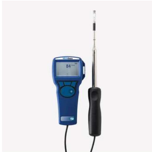
FIGURE 1.3 – Anémomètre à fil chaud portable.
