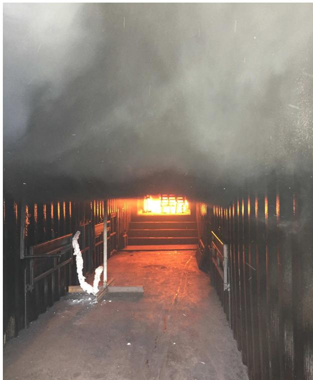
FIGURE 3.15 – Stratification des fumées lors des essais dans le caisson.
