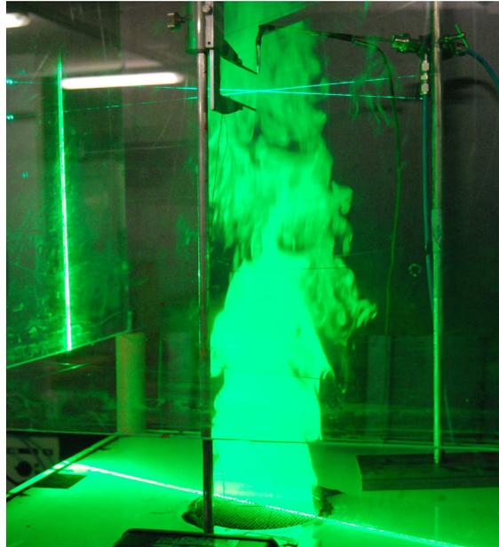
FIGURE 3.3 – Disposition des points de mesures LDV, Pitot et CCV dans le panache d'air chaud.
