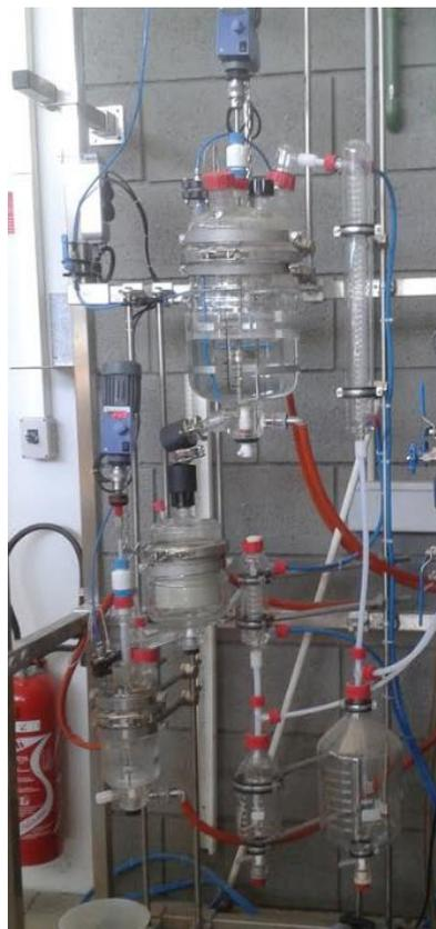
Figure 24 : Pilote d'évaporation du LaTEP
