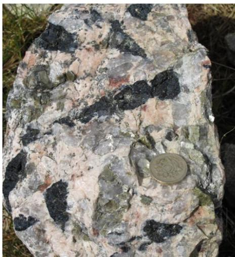
Figure 3 : Exemple d'une roche lithinifère (Brown et al., 2016)
