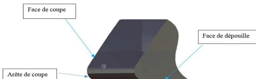
Figure 1-1 : Différentes parties d'un outil de coupe en usinage.
