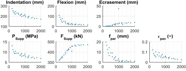
Figure III-6 : Variation des 7 sorties en fonction de  $e_{pav}*A_{pav}$ . Le point référence est indiqué en rouge
