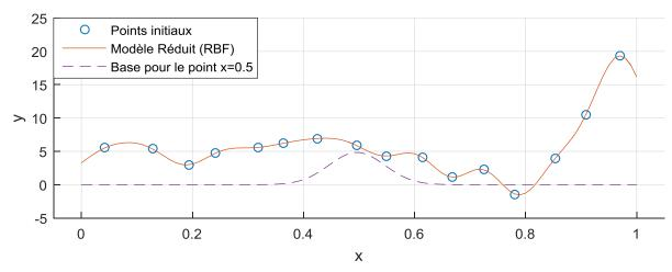
Figure I-32 : Modèle réduit à fonctions radiales : base Gaussienne
