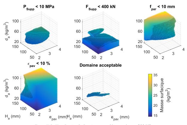
Figure V-9: Visualisation du domaine acceptable, avec  $A_{pav} = 300 \text{ MPa}$
