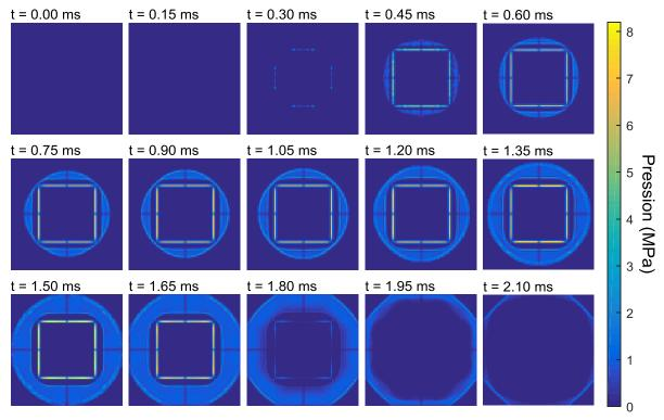
Figure II-7 : Sandwich de référence : pression de contact sur la peau arrière
