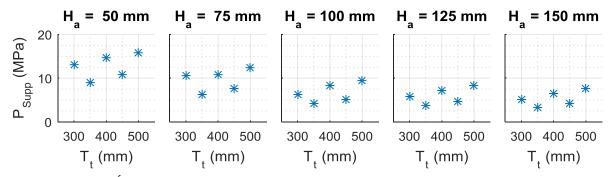
Figure III-10 : Évolution de la pression maximale appliquée au support en fonction de la taille du trou
