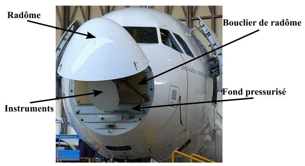
Figure 1: Pointe avant d'un A320
