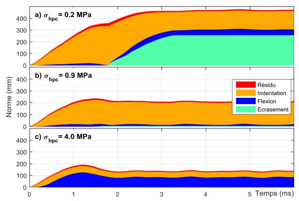
Figure II-18 : Évolution des modes de déformée au cours du temps pour trois boucliers
