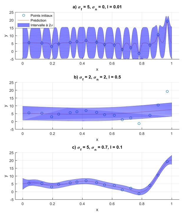
Figure I-33: Processus gaussiens pour trois jeux d'hyper-paramètres
