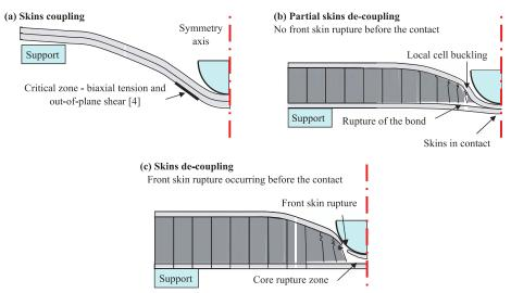
Figure I-20 : Effet de la hauteur de l'âme sur le comportement des peaux [Kolo13]
