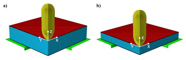
Figure II-2 : Modèles géométriques pour deux bouliers a)  $H_a = 100 \text{ mm}$ ,  $T_t = 400 \text{ mm}$  a)  $H_a = 50 \text{ mm}$ ,  $T_t = 500 \text{ mm}$
