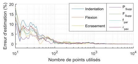
Figure IV-9 : Étude de convergence de l'estimation de l'écart-type moyen, pour les 7 sorties
