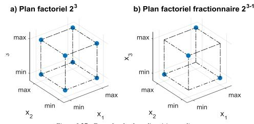
Figure I-27 : Exemples de plans d'expériences discrets
