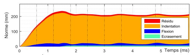
Figure II-16 : Évolution des modes de déformée au cours du temps pour le bouclier de référence
