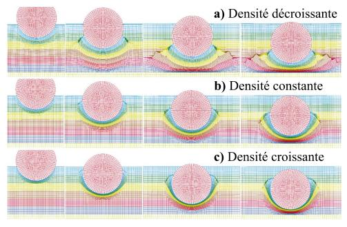
Figure I-21 : Optimisation du gradient de densité pour un impact dur [Zhan13]
