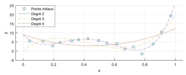
Figure I-31: Modèles réduits polynômiaux
