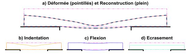
Figure II-11 : Décomposition de la déformée à t = 3 ms du bouclier  $\sigma_{hvc} = 0.2$  MPa
