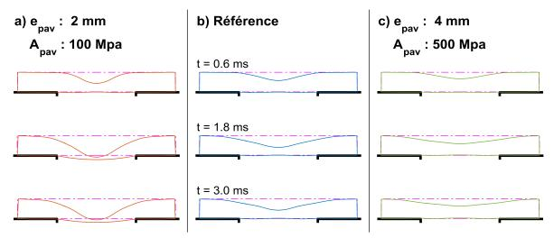
Figure III-7 : Profils des déformées des deux boucliers extrêmes et de la référence
