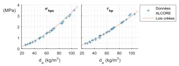
Figure V-8 : Approximation des données matériaux ALCORE pour le nida 5052
