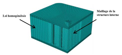
Figure I-13 : Modélisation fine dans la zone d'intérêt, homogénéisée autour [Buit10]
