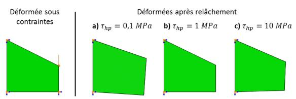
Figure II-3 : Déformées après relâchement en fonction de  $\tau_{hp}$ , avec  $\sigma_{hpc}=1$  MPa
