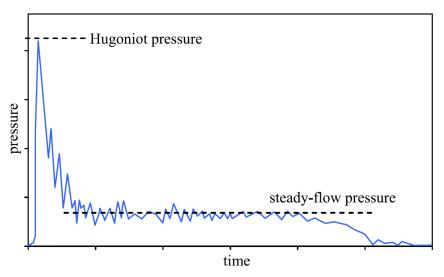
Figure I-3 : Courbe typique de pression au centre de la cible rigide [Heim11]
