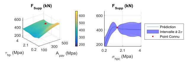
Figure IV-8 : Visualisation du modèle réduit par des coupes 2D ou 1D autour du point connu :  $\{\sigma_{hpc}=1.53\ MPa, \tau_{hp}=2.86\ MPa, e_{pav}=2.34\ mm, A_{pav}=444\ MPa, H_a=145\ mm, T_t=328\ mm\}$
