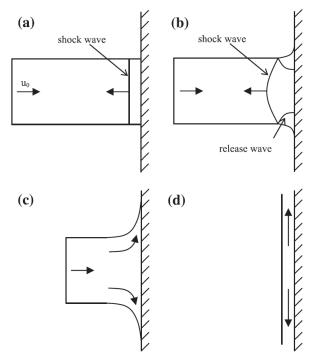
Figure I-2: Comportement d'un oiseau lors d'un impact normal sur une cible rigide [Barb78]
