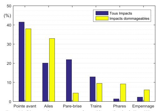
Figure I-1 : Répartition des impacts ayant endommagé l'avion (données de [Denn08])
