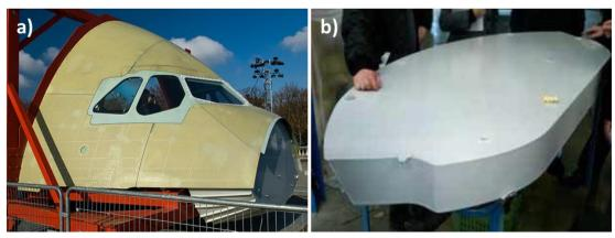
Figure II-1: a) Pointe avant A350 b) Bouclier de radôme A350 [STELIA Aerospace]
