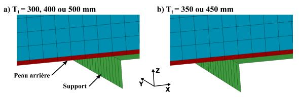
Figure III-11 : Zoom sur le contact entre la peau arrière et le support
