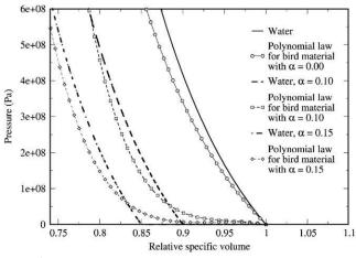
Figure I-9 : Équations d'état pour différentes valeurs de porosité [Airo06]
