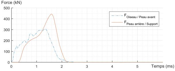
Figure II-6 : Sandwich de référence : efforts de contact Force de l'oiseau sur la peau avant et force de la peau arrière sur le support
