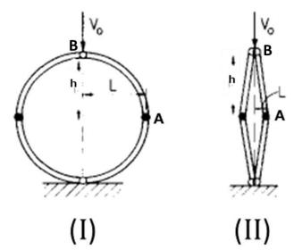
Figure I-14: Classification des structures en deux types [Call84]
