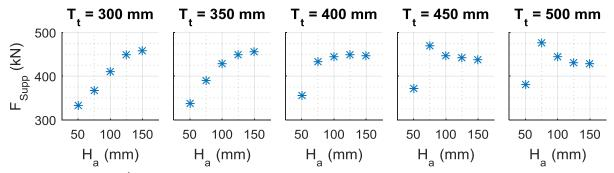
Figure III-12 : Évolution de l'effort maximal appliqué au support en fonction de la hauteur de l'âme
