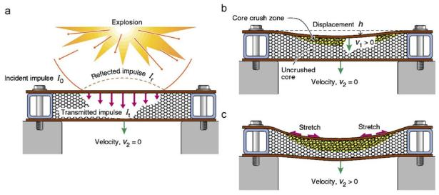
Figure I-22 : Chronologie de la déformation d'un sandwich sous blast [Dhar08]
