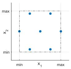
Figure I-28 : Plan de Doehlert en 2D
