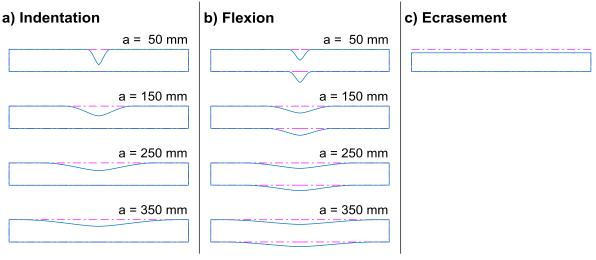
Figure II-10 : Une partie des vecteurs de base utilisés pour la décomposition
