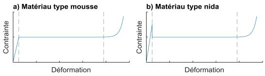
Figure I-12 : Courbes d'écrasement type des matériaux cellulaires
