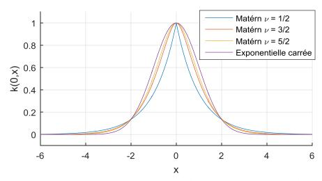
Figure IV-4 : Les quatre noyaux testés, avec une longueur caractéristique égale à 1
