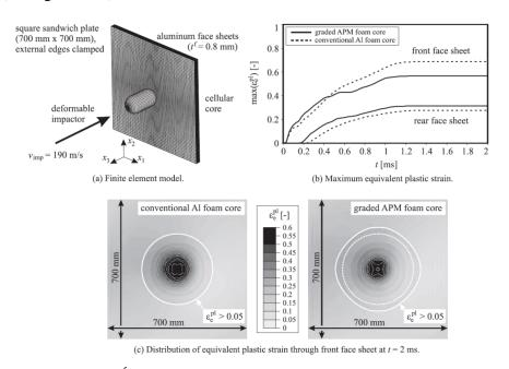
Figure I-10 : Étude de l'intérêt d'une âme à gradient de propriétés [Hohe12]
