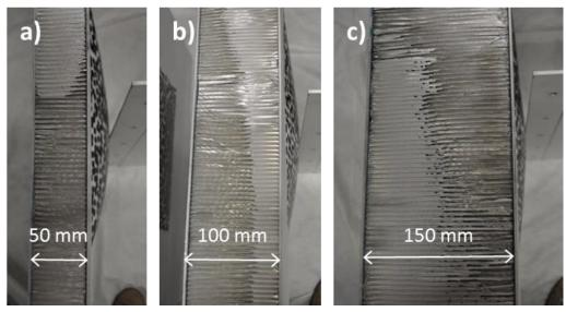
Figure A1-6 : Influence de la hauteur de l'âme sur la flèche résiduelle a) Éprouvette 3 ( $H_a=50\ mm$ ) b) Éprouvette 1 ( $H_a=100\ mm$ ) c) Éprouvette 5 ( $H_a=150\ mm$ )
