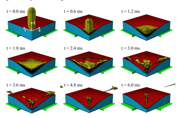
Figure II-4 : Sandwich de référence : déformation durant l'impact
