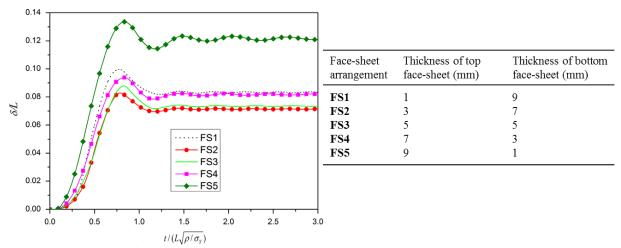
Figure I-23 : Évolution de la flèche arrière pour différents ratio d'épaisseur des peaux [Liu14]
