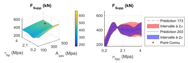
Figure IV-14 : Visualisation des mêmes coupes que sur la Figure IV-8, avec les nouveaux modèles réduits
