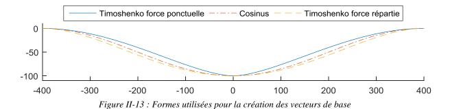
Afin de comparer ces trois formes, une base est créée avec chacune, et la déformée présentée Figure II-11 est décomposée sur ces trois bases. Sur la Figure II-14, on peut voir la norme de chacune des composantes et du résidu pour chacune des bases.
