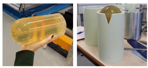
Figure A1-1 : a) Substitut en gélatine utilisé b) Substitut dans son sabot
