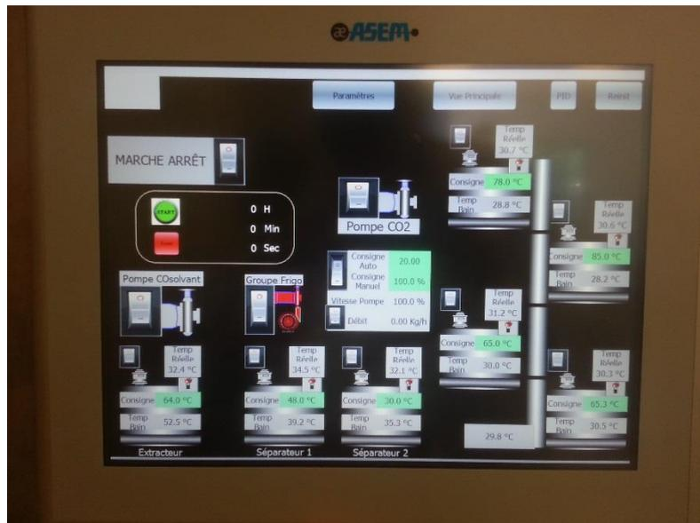
Figure 2-6 : Panel PC qui permet la gestion de l'installation
