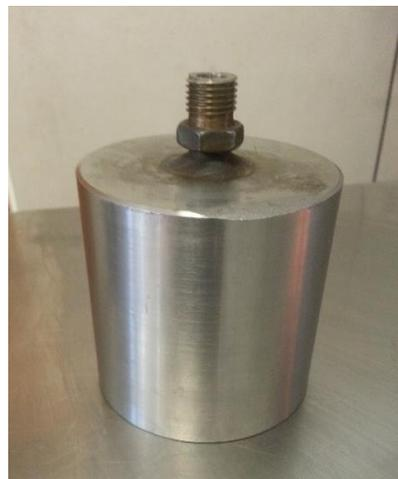
*Figure 2-2 : Tête de colonne d'origine du pilote avec un seul piquage*
