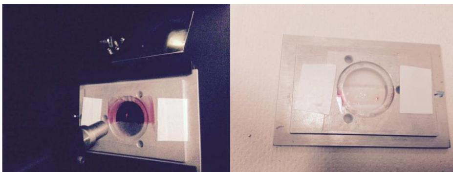
**Figure 3.12** : Apparence du film mince en présence du composé **34** avant (à gauche) et après photopolymérisation (à droite)
