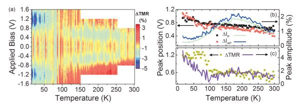
FIGURE AVII : **Impact de l'excitation avec de la lumière de 3.05 eV :** (a) Carte couleur 2D de la diminution relative de la TMR due à l'excitation optique dans l'espece de paramètre (V,T), (b) la position du maximum des pic et leur amplitude maximale extraite des  $\Delta I_{\sigma}$  (V, T) pour les configurations magnétiques parallèle et antiparallèle et (c) la position du maximum des pic et leur amplitude maximale extraite des données représentées dans le panneau (a).
