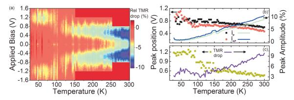
FIGURE AIV : **Propriétés magnétorésistive dans l'espace de paramètre (V,T) : (**a) Carte couleur 2D de la diminution relative de la TMR due à l'excitation thérmique, (b) la position du maximum des pic et leur amplitude maximale extraite des  $\hat{I}$  pour les configurations magnétiques parallèle et antiparallèle et (c) la position du maximum des pic et leur amplitude maximale extraite des données représentées dans le panneau (a).
