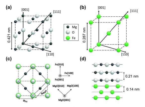
FIGURE AI : Structure de l'interface Fe/MgO (001) : La structure NaCl et cubique centrée du MgO et du fer sont schématisé dans les panneaux (a) et (b) respectivement. Une vue de dessus ainsi qu'un vue en tranche de l'interface Fe/MgO(001) sont représentées dans les panneaux (c) et (d). On constate que la direction MgO[100] est parallèle à la direction Fe[110].
