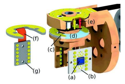
FIGURE AIX : **Insert versatile à température variable :** (a) Coupe en tranche du porte échantillon et (b) une vue d'ensemble. Les différents élements sont discutés plus en détails dans le manuscit.
