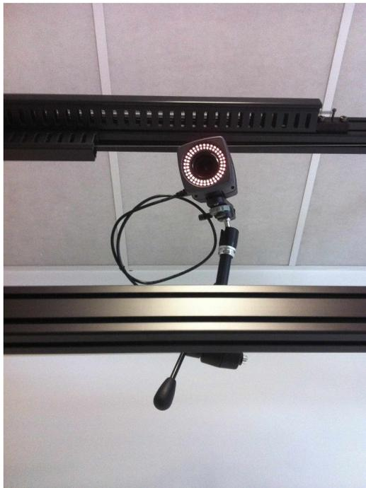
Figure 1.7 – Caméra infrarouge
