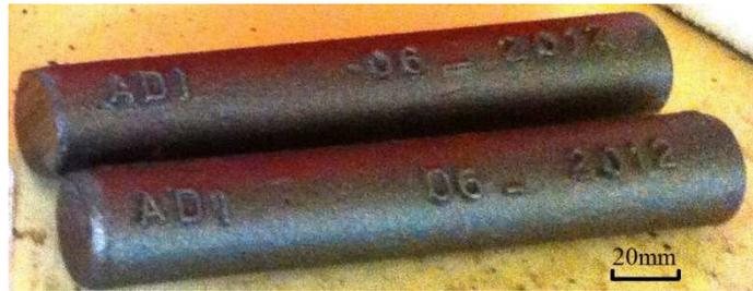
Figure 37 : Barreaux de FGS de composition ADI utilisés pour la fabrication des éprouvettes
