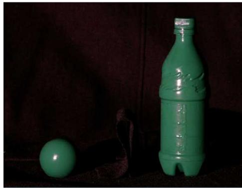
FIGURE 4.5 – La géométrie d'une bouteille est retrouvée grâce à l'utilisation d'une sphère, dont la géométrie est connue, recouverte de la même peinture. Les points ayant la même valeur possèdent la même normale. Image extraite de l'article [HS05].
