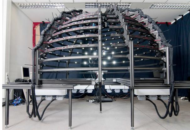
FIGURE 2.10 – Système d’acquisition proposé par Schwartz et al. [SSW<sup>+</sup>14], constitué de 151 caméras, 151 lumières LED et 9 projecteurs afin d’effectuer une reconstruction préalable de la géométrie des objets.
