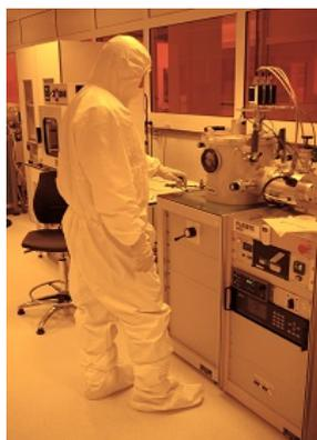
Figure IV-21- Bûti de pulvérisation cathodique assistée DC MP 300
