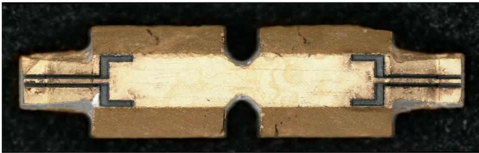
Figure IV-28- Filtre 2 pôles TM-DAR après métallisation et gravure des accès coplanaires
