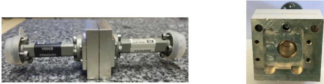
Figure II-19- Cavité (SCR) 60 GHz
