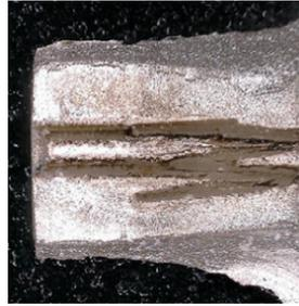
Figure IV-34- Rupture de la ligne centrale du filtre
