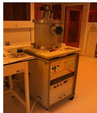
Figure IV-22- Evaporateur à effet joule Méca 2000
