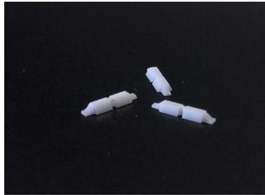
Figure IV-7- Filtres 2 pôles après calcination/ recuit
