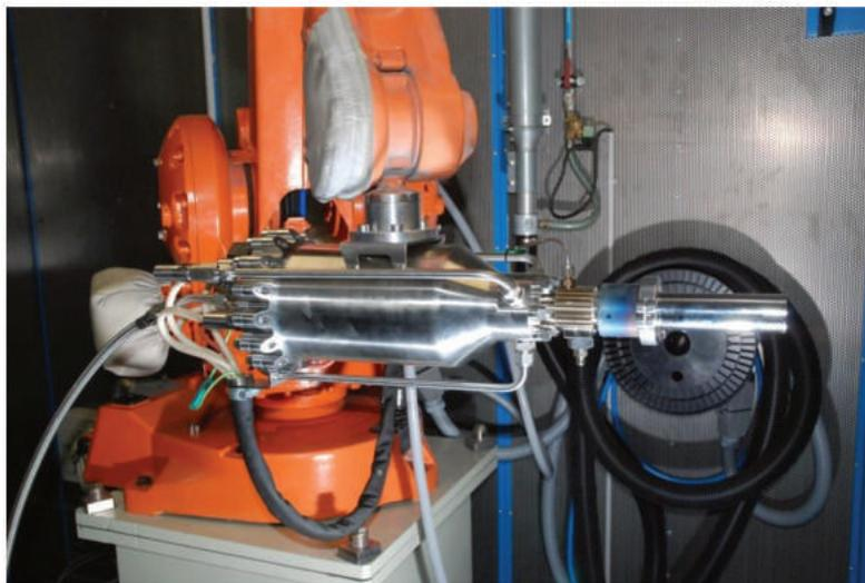
Figure 81 : Pistolet de projection à froid IMPACT INNOVATION GMBH.
