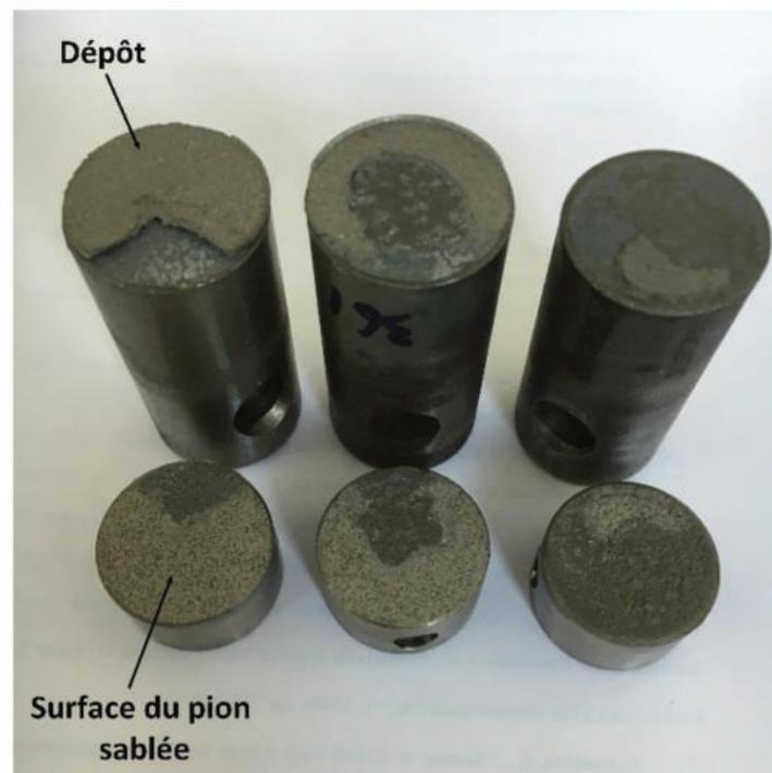
Figure 73 : Faciès de rupture des dépôts Nucalloy/alumine réalisés avec une poudre préparée par mécanofusion.
