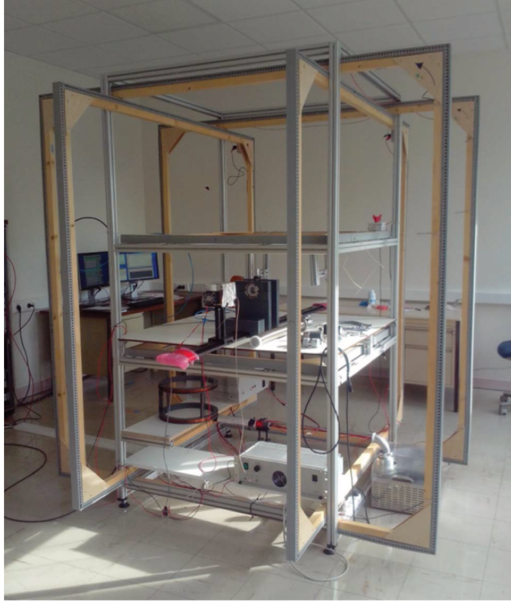
FIGURE 3.3 – Photographie du banc de test montrant l’agencement des bobines. La cellule cylindrique disposée au centre est orientée selon l’axe \mathbf{x} et la direction verticale est définie par l’axe \mathbf{z} . La structure en aluminium soutenant les bobines a une dimension de 1\text{ m} \times 1\text{ m} \times 2\text{ m} .
