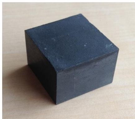
Figure 54: Echantillon de \text{Pr}_{1-x}\text{Sr}_x\text{MnO}_3 utilisé pour des mesures de la conductivité et d'effusivité
