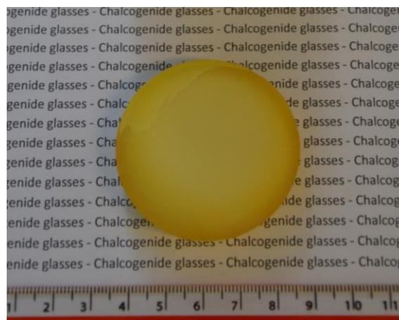
Figure 3.5 : Synthèse du verre  $70,5\text{GeS}_2-14,5\text{Ga}_2\text{S}_3-15\text{CsCl}$  en diamètre 50mm
