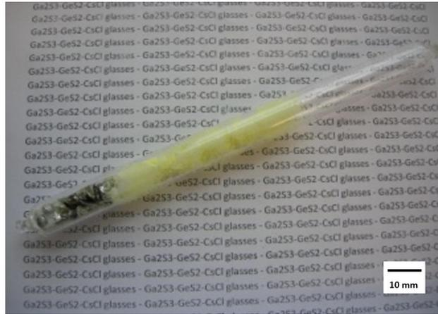
Figure 2.7 : Tube de silice scellé contenant les réactifs
