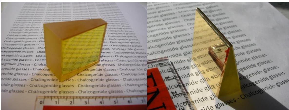
Figure 3.19 : Prismes utilisés pour la mesure par la méthode Littrow (gauche  $75\text{GeS}_2\text{-}15\text{Ga}_2\text{S}_3\text{-}10\text{CsCl}$  sans dépôt d'or et droite  $65\text{GeS}_2\text{-}20\text{Ga}_2\text{S}_3\text{-}15\text{CsCl}$  avec dépôt d'or)
