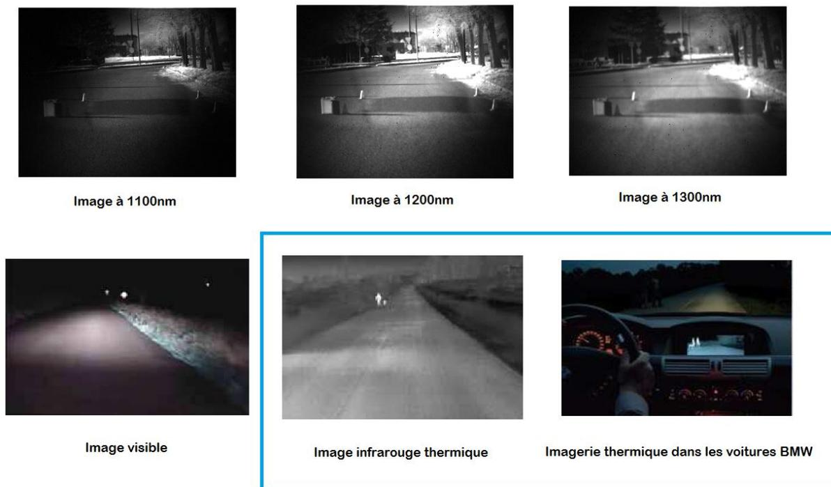
Figure 1.10: En haut, images dans la bande SWIR permettant de détecter la présence de verglas. En bas, l'imagerie thermique permettant de détecter la présence de piétons déjà présente dans les voitures BMW
