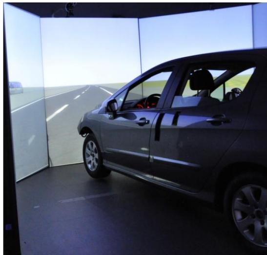
Le véhicule instrumenté est positionné au centre de ces dix écrans dont trois se situent en face du conducteur, alors que trois autres se situent à l'arrière du véhicule (Figure 12). La vision arrière latérale est assurée par deux écrans fixes installés de chaque côté du véhicule. Le taux de rafraichissement de tous ces écrans est de 60Hz. L'automobiliste a la possibilité de
