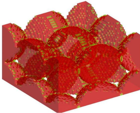
FIGURE 3.20 – Géométrie initiale du milieu poreux 3D, où le biofilm est indiqué en vert, le solide en rouge. L'écoulement est orienté de la gauche vers la droite.
